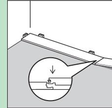
9 Estreche la primera fila o, como mínimo, corte la lengüeta para obtener la primera distancia al muro. Si el muro es curvado o irregular, la primera fila se debe cortar y adaptar al contorno del muro. Utilice como mínimo dos cuñas en el lado largo de cada plancha. Corte la lengüeta de la primera plancha también en el lado corto. Esta plancha quedará por tanto con la lengüeta de plástico a la derecha.
