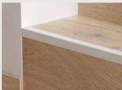
PERFIL DE ESCALERA, PLATA 2500 x 50 x 25 mm. Se adapta a suelos de entre 7 y 15 mm de grosor. Aluminio.
