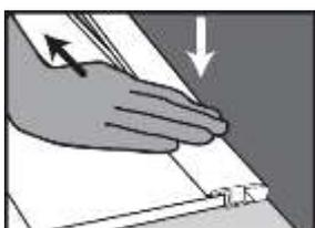
En primer lugar, sierre el perfil a la longitud adecuada. Con ayuda de la cuchilla, corte la sección B para formar un perfil de borde.
