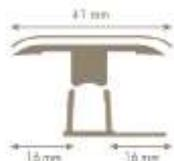
Sierre el perfil hasta lograr la longitud adecuada. Corte la sección A y la B con la cuchilla para formar el perfil de dilatación.
