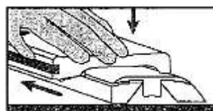
Al hacer el corte, coloque siempre el perfil horizontalmente sobre una base estable.
